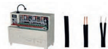
EIBC-TT2008AS - Máquina Automática de Torção e Estanhagem em Cabos Paralelos
